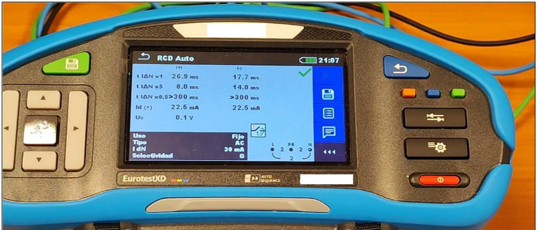
Prueba de medición de RCD, mostrando las 6 operaciones del protector diferencial en los ciclos positivos (+) y negativos (-), pasando la prueba de operación en tiempo y corriente (Protección o desconexión automática de la alimentación).
